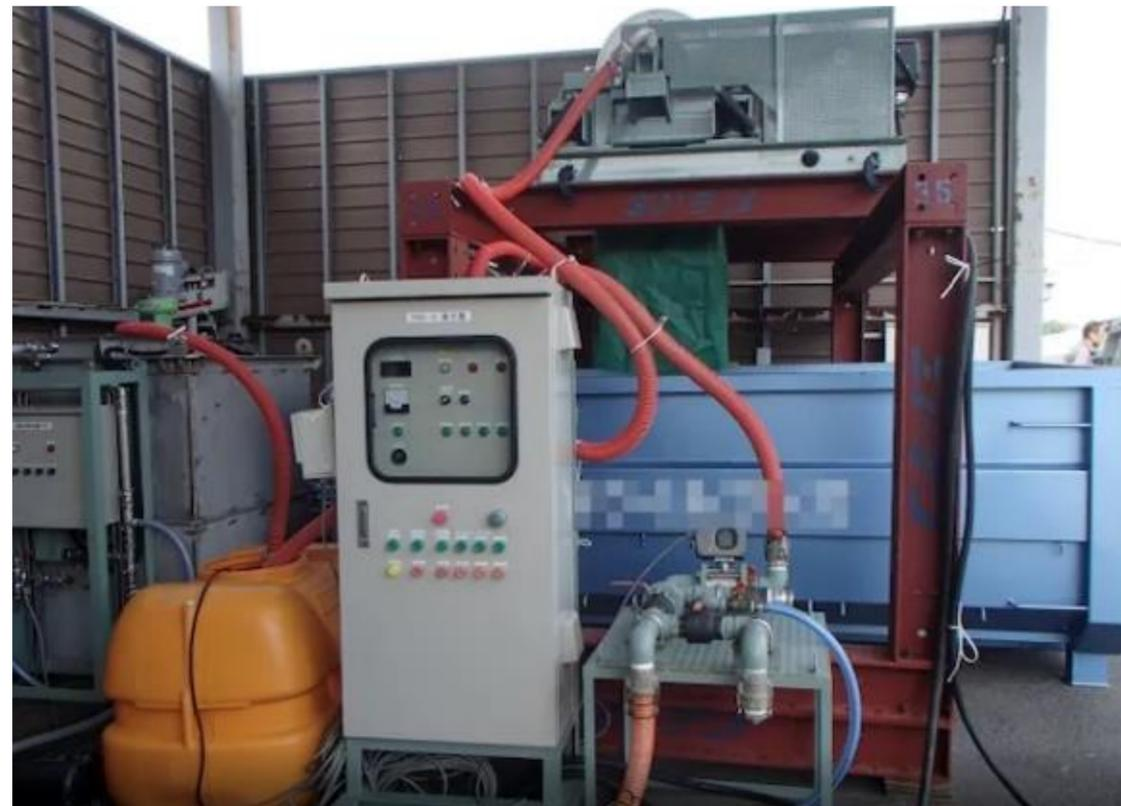
仮設水処理システムでは、設備一式を現場に運んで設置し、処理を行い、処理が終われば撤去します。この方法だと、目的に合わせカスタマイズした設備(プラント)が持ち込まれるため、対象物を確実に処理ができます。また、必要な期間だけ使うことができるので永久的に使う設備を導入するよりもコストを圧縮できます。さらには、従来のような外部施設で処理を行う場合、水や汚泥を運搬する必要がありますが、現場に導入した仮設水処理システムでは、現場で処理ができるので廃棄する水の量を減らすことができ、運搬や産業廃棄物の処理の費用を大幅に減らすことが可能です。
